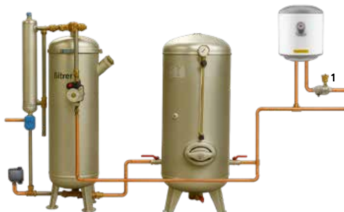
J-filter med avluftare special mot luftpuffar
